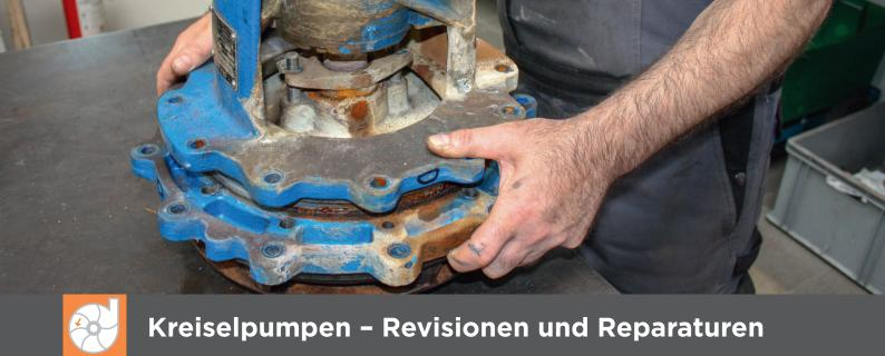
Wir revidieren und reparieren Kreiselpumpen unabhängig vom Fabrikat und Fördermedium. Durch unseren vielseitigen Maschinenpark und dem eigenen Hartchromwerk sind wir in der Lage, kurzfristig einzelne Pumpenkomponenten zu fertigen und zu beschichten.
